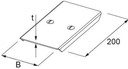
Der Bodenkanal-Steigstück-Deckel BKSDR wird auf dem Bodenkanal-Steigstück BKS aufgesetzt und schützt Kabel und Versorgungsleitungen vor Funkenflug und anderen mechanischen Einwirkungen. Er hat eine dem Steigstück entsprechende Breite von 100 bis 600 mm. Der Bodenkanal-Steigstück-Deckel besteht aus sendzimir-feuerverzinktem Stahl ohne Prägung. Bei einer maximalen Fachgröße von 200 mm garantieren wir eine geprüfte Belastbarkeit von 5,00 kN nach EN 50085-2-2. Drehriegel sind vormontiert.
