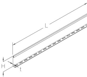
Mithilfe des Bodenkanal-Trennstegs BKRT 100 lassen sich Kabel und Leitungen mit unterschiedlichen Funktionen oder Spannungen räumlich voneinander getrennt im gleichen Bodenkanal führen. Darüber hinaus sorgen die Trenstege für eine optimale Ableitung der vertikalen Nutzlasten, die auf das System einwirken. Der Trennsteg wird mit dem Bodenkanal verschraubt. Er ist 100 mm hoch, 3000 mm lang und besteht aus sendzimir-feuerverzinktem Stahl.
