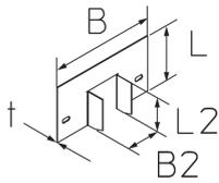
Die Bodenkanal-Reduzierung BKRKK 100 ermöglicht den Anschluss eines Kleinkanals an einen Bodenkanal. Sie hat eine Höhe von 95 mm und besteht aus sendzimir-feuerverzinktem Stahl. Der Seitenholm des Bodenkanals wird dort ausgeschnitten, wo der Kleinkanal ansetzen soll. Anschließend wird die Bodenkanal-Reduzierung am Ausschnitt verschraubt und der Kleinkanal auf die Laschen der Reduzierung geschoben.
