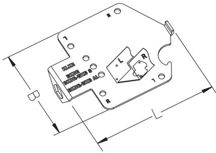
Das Bodenkanal-Multitool BKMT kommt primär als Schablone zum Einsatz. Es kann zum Anzeichnen der Positionen von Verbindern und Drehriegeln verwendet werden. Außerdem eignet sich das Tool zum Ausschlagen der Butzen und zum Festziehen der Drehriegel. Es besteht aus Edelstahl.
