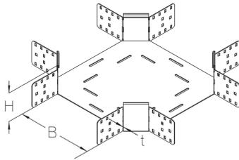
Die Bodenkanal-Kreuzung BKK 110 mit integrierten Verbindern dient als Formteil für sich horizontal kreuzende Bodenkanäle. Sie hat eine Höhe von 110 mm und weist Breiten von 100 bis 600 mm auf. Sie besteht aus sendzimir-feuerverzinktem Stahl. Zur Ableitung von vertikalen Nutzlasten müssen ab einer Breite von  $\geq 300$  mm ein Trennsteg und ab einer Breite von  $\geq 500$  mm zwei Trennstege verbaut werden. Die Kreuzung wird in die Bodenkanäle eingeschoben und anschließend verschraubt.
