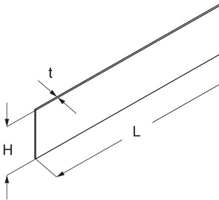
Die Bodenkanal-Seitenverkleidung BKHZSV wird bei Aufständigung des Bodenkanals durch Bodenkanal-Halter BKHZ verwendet und mittels Bohrschraube BS 5.5x19 befestigt. Die Seitenverkleidungen schützen bei aufgeständerten Bodenkanälen vor Tritten und Schmutz und schließen das Bodenkanalsystem unterhalb ab. Sie haben eine Höhe von 69 oder 79 mm, eine Länge von 1000, 1500 oder 3000 mm und bestehen aus sendzimir-feuerverzinktem Stahl.
