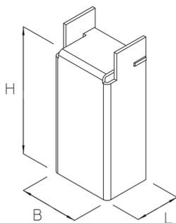
Die Bodenkanal-Halter-Unterstützung BKHRU dient der Unterstützung des Bodenkanal-Halters BKHR ab einer Länge von 400 mm. Die Unterstützung muss nicht mit dem Boden verschraubt werden. Das Setzen von Dübeln entfällt. Sie besteht aus sendzimir-feuerverzinktem Stahl.
