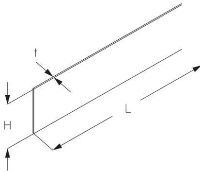
Die Bodenkanal-Seitenverkleidung BKHCSV wird bei Aufständigung des Bodenkanals durch Bodenkanal-Halter BKHC verwendet und mittels Bohrschraube BS 5.5x19 befestigt. Die Seitenverkleidungen schützen bei aufgeständerten Bodenkanälen vor Tritten und Schmutz und schließen das Bodenkanalsystem unterhalb ab. Sie haben eine Höhe von 90 mm, eine Länge von 1000, 1500 oder 3000 mm und bestehen aus sendzimir-feuerverzinktem Stahl.
