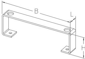
Der Bodenkanal-Halter BKHC dient der Aufständigung des Bodenkanals, wenn z.B. unterhalb des Bodenkanalsystems Medienleitungen installiert werden sollen. Es wird ein Stützabstand von 1,5 m empfohlen. Der C-Bügel hat eine Höhe von 90 mm und besteht aus tauchfeuerverzinktem Stahl.
