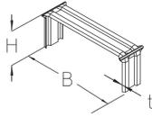
Die Bodenkanal-Deckelunterstützung BKDU 110 sorgt für zusätzlichen Halt der Deckel. Sie wird mit dem geöffneten Ende nach unten in den Bodenkanal gestellt. Die Deckelunterstützung hat eine dem Bodenkanal entsprechende Breite von 200 bis 600 mm, eine Höhe von 110 mm und besteht aus tauchfeuerverzinktem Stahl.
