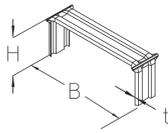
Die Bodenkanal-Deckelunterstützung BKDU 100 sorgt für zusätzlichen Halt der Deckel. Sie wird mit dem geöffneten Ende nach unten in den Bodenkanal gestellt. Die Deckelunterstützung hat eine dem Bodenkanal entsprechende Breite von 200 bis 600 mm, eine Höhe von 100 mm und besteht aus tauchfeuerverzinktem Stahl.
