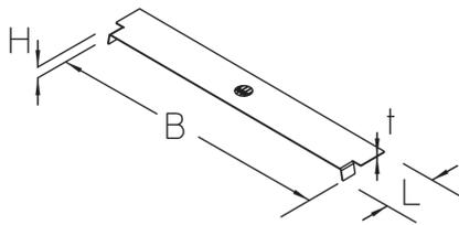
Die Bodenkanal-Deckelstoßleiste BKDSL dient der spaltfreien Abdeckung der begehbaren Bodenkanäle genau dort, wo Deckel aufeinandertreffen. Sie sorgt somit für zusätzlichen Schutz vor Funkenflug und anderen mechanischen Einwirkungen. Sie hat eine dem Bodenkanal entsprechende Breite von 100 bis 600 mm und besteht aus sendzimir-feuerverzinktem Stahl.
