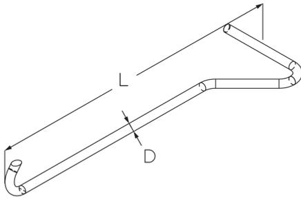
Mithilfe des Bodenkanal-Deckelhebers BKDH lassen sich die Bodenkanal-Deckel mit befestigten Bodenkanal-Deckelhalteklammern BKDHK lösen. Dazu werden die Deckelheber beidseitig am Deckel direkt neben den Deckelhalteklammern eingehakt und angehoben. Dies wird bei allen weiteren Positionen wiederholt, bis alle Deckelhalteklammern vom Bodenkanal entrastet sind und der Deckel angehoben werden kann. Der Bodenkanal-Deckelheber besteht aus galvanisch verzinktem Stahl und hat eine Länge von 400 mm.
