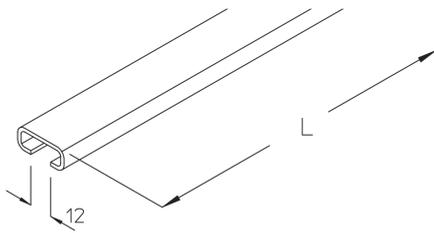
Die Profilschiene B 3 ist ungelocht und besteht aus einem C-Profil 28 x 12 mm mit einer Schlitzweite von 12 mm (Materialstärke = 2 mm). Verschiedene Materialien und Oberflächen sorgen dafür, dass die Korrosionsanforderungen unterschiedlichster Anwendungsgebiete erfüllt werden. Sie ist in den Längen 3000 oder 6000 mm lieferbar.
