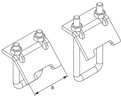
Die Trägerklemme AVSKGB 41 dient zur Befestigung von Montageschienen (A 41, KHA 41, KHAL 41, KHA 42) an waagrecht verlaufenden Stahlträgern.
