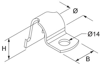
Die Rohrschelle AVRS dient der Befestigung von Rohren in C-Montageschienen (A 41, KHA 41, KHAL 41) mit 22 mm Schlitzweite. Sie besitzt ein Befestigungsloch mit  $\varnothing$  14 mm und besteht aus tauchfeuerverzinktem Stahl. Befestigungszubehör muss, je nach Anwendungsfall, gesondert bestellt werden.
