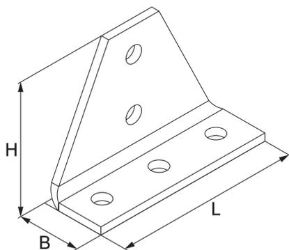
Der Schienenstoßverbinder AVLWBL dient zur starren Verbindung von zwei Montageschienen (A 41, KHA 41, KHAL 41) im T-Stoß. Er besitzt Befestigungslochungen mit  $\varnothing$  13 mm und besteht aus tauchfeuerverzinktem Stahl. Befestigungszubehör muss, je nach Anwendungsfall, gesondert bestellt werden.
