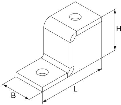
Der Schienenstoßverbinder AVBLA dient zur Verbindung von zwei Montageschienen (A 41, KHA 41, KHAL 41) im T-Stoß. Er besitzt Befestigungslochungen mit  $\varnothing$  13 mm und besteht aus tauchfeuerverzinktem Stahl. Befestigungszubehör muss, je nach Anwendungsfall, gesondert bestellt werden.
