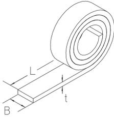
Das Antirutschband ARB wird auf der Oberseite der Bodenkanal-Seitenstege aufgeklebt. Dadurch wird die Rutschgefahr zwischen den begehbaren Deckeln und den Bodenkanälen deutlich reduziert. Das Antirutschband ist stark komprimierbar und besteht aus Ethylen-Propylen-Kautschuk auf Rolle, einseitig klebend. Es hat eine Breite von 8 mm sowie eine Länge von 10 m.
