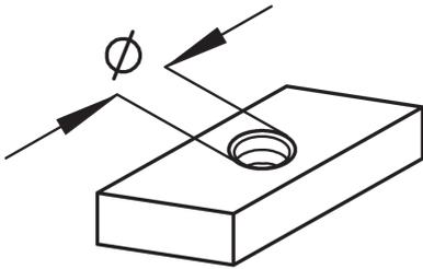
Ankermuttern AM 12 sind Gewindeplatten, die bei Profilschienen B 3 und B 6 eingesetzt werden. Durch eine 90°-Drehung nach dem Einlegen oder Einkippen steht die Gewindebohrung mittig. Die auch als Gleitmuttern bezeichneten Ankermuttern werden vorzugsweise zur Abstandsmontage mit langen Schrauben oder Gewindestäben verwendet. Sie bestehen aus tauchfeuerverzinktem Stahl mit Gewinden M6 oder M8 sowie aus Edelstahl mit Gewinde M8.
